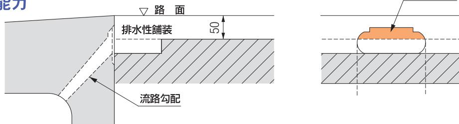
●排水孔には排水フィルターを装着するため、有効通水断面積は有効断面積の38%の面積になります。
