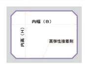
最小内空断面寸法 内幅800mm×内高800mm
